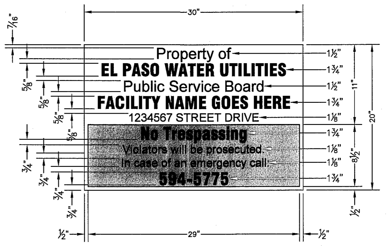
4 NO TRESPASSING WARNING SIGN SCALE: N.T.S.
