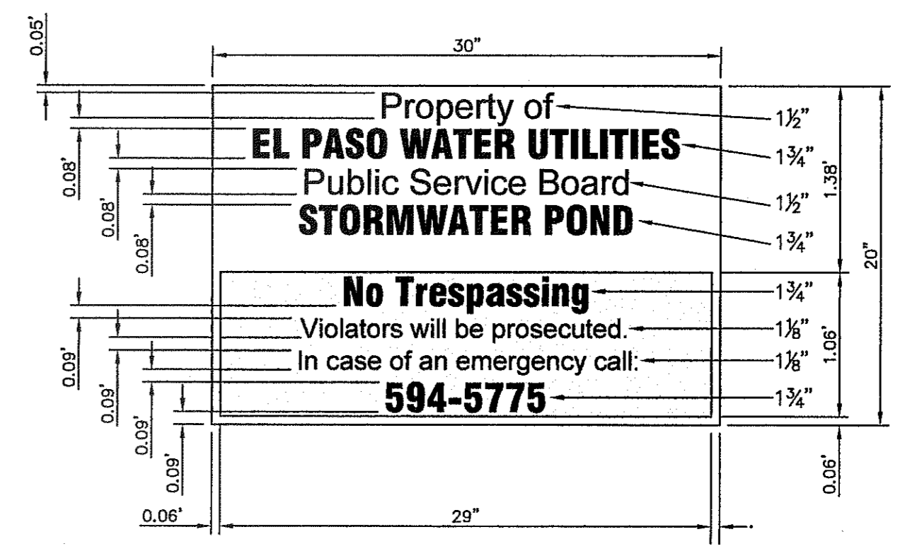
5 NO TRESPASSING WARNING SIGN SCALE: N.T.S.
