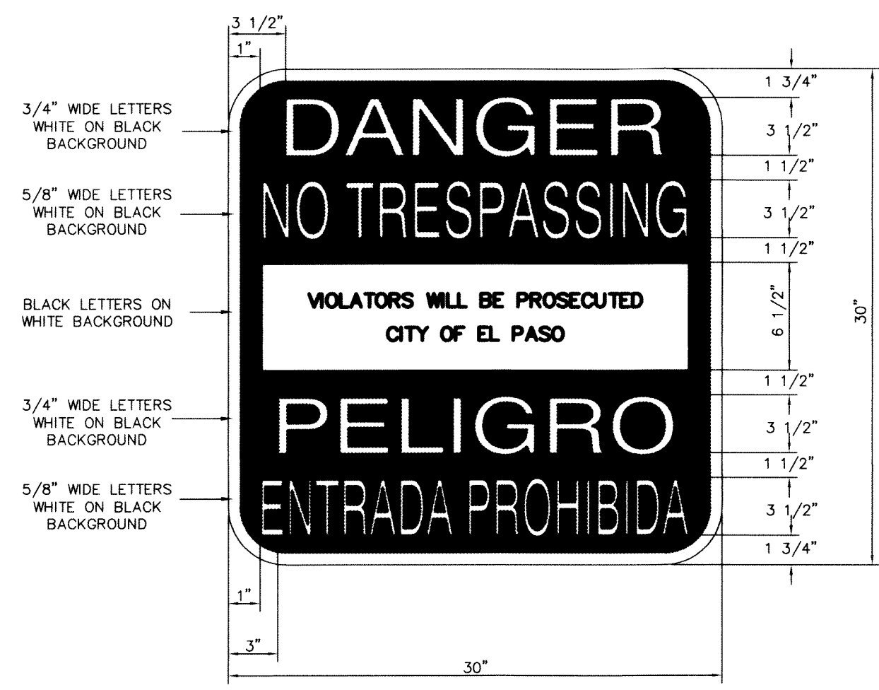
4/30 NO TRESPASSING WARNING SIGN SCALE: N.T.S.
